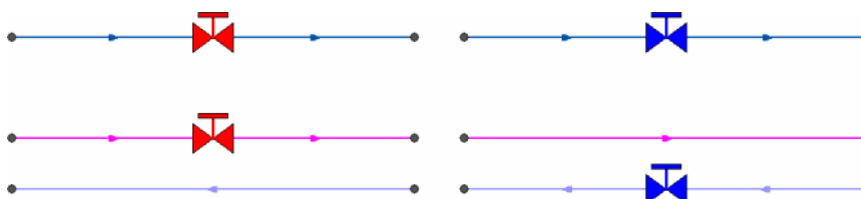
Рисунок 2.33. Сверху: однолинейное изображение сети, снизу – внутренне представление
